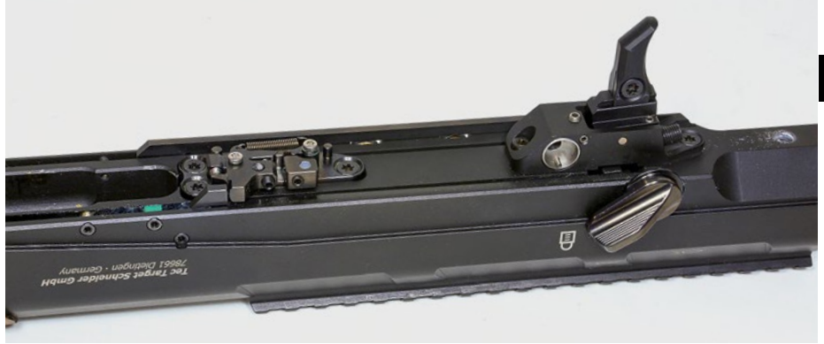
Der Abzug überträgt die wirkenden Kräfte über einen sehr langen Weg nach vorn aufs System – ein wahres Meisterwerk.
